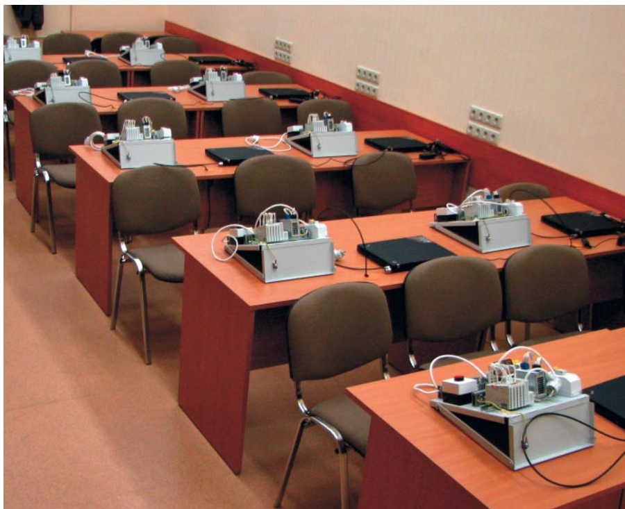
Рис. 5. Лаборатория, оборудованная комплексом стендов для изучения способов управления электродвигателем
