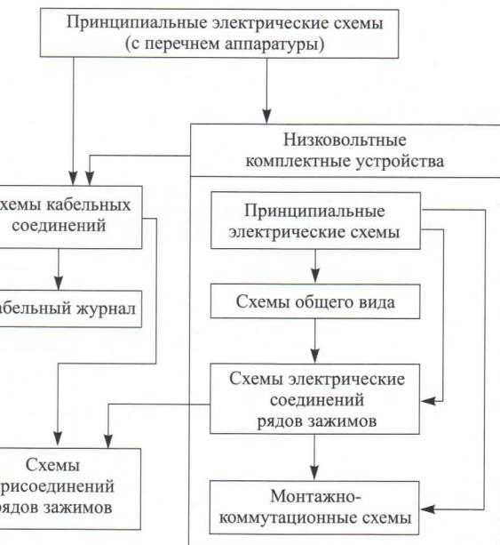
Рис. 1. Структура проектной документации
